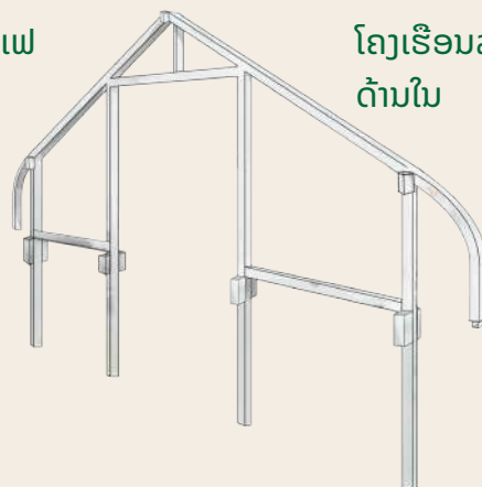
ເຫຼັກຕໍ່ລະຫວ່າງເທິງຫຼັງຄາ ແລະ ເຫຼັກຕໍ່ລະຫວ່າງຫຼັງຄາດ້ານຂ້າງ ແມ່ນໃຊ້ເຫຼັກ 4 x 4, ຄວາມຍາວ 2 ແມັດ
